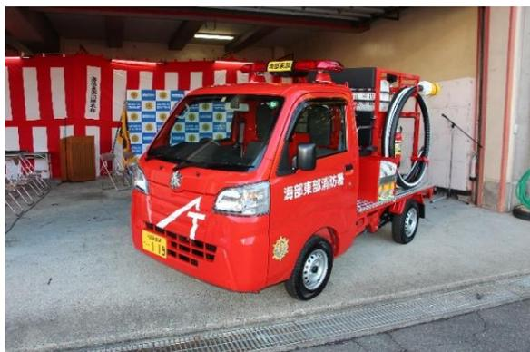
☆軽自動車をベースに造られ、荷台中央に100リットルの水槽を設置し、水中ポンプにて25ミリホースから弱めの圧力で放水でき、幼年期の子供でも体験することができます。
